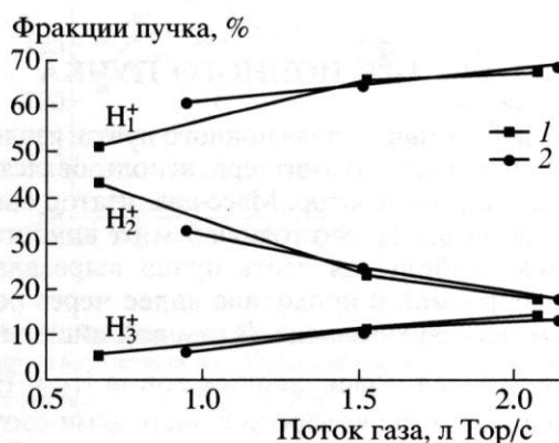
Рис. 10. Относительное содержание ионов в пучке в зависимости от потока газа. 1 – 2 А, 2 – 1.7 А.
